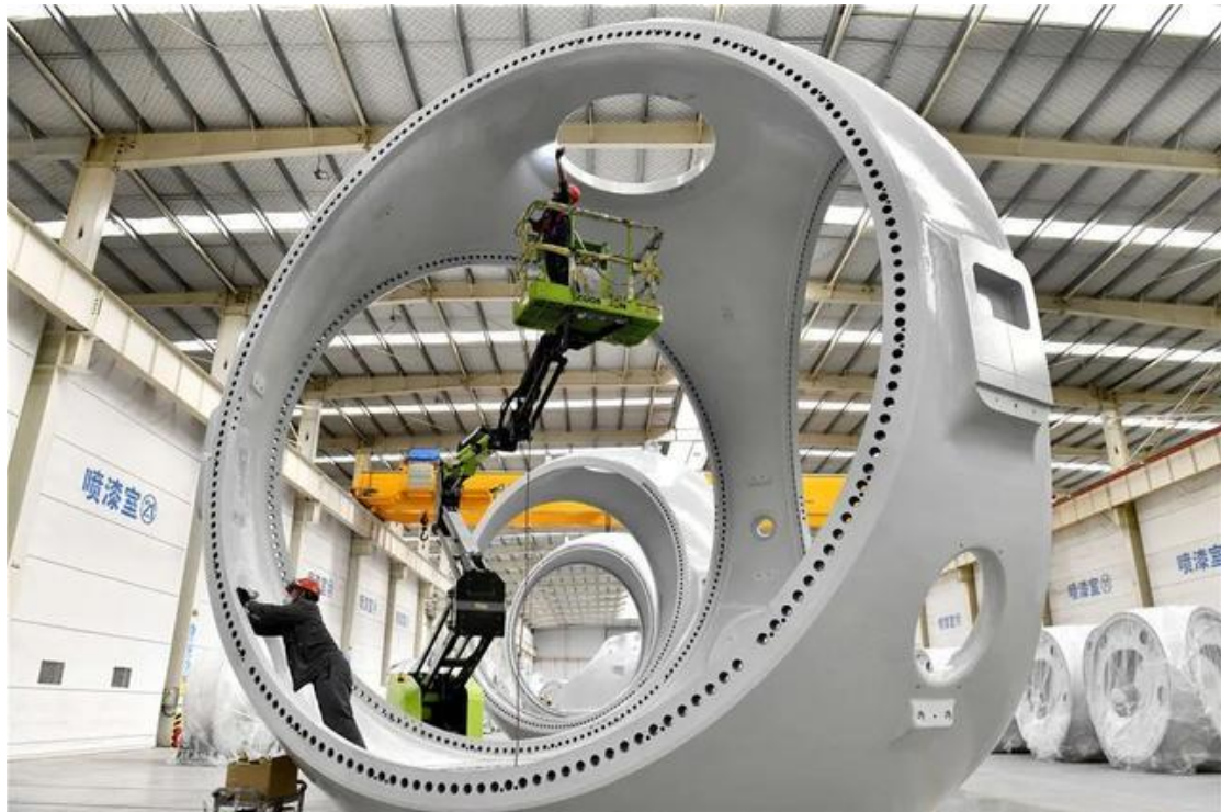
在山东省惠民县风电装备产业基地涂装车间，工作人员对风电轮毂进行涂装（2022年6月7日摄）。新华社记者 郭绪雷 摄
